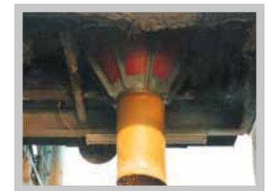
Auslauftrichter für stationäre Betonmischer ■ Trichtereinlagen im „Kaffeefilter-Prinzip“ ■ Beliebige Größen lieferbar ■ Auch mit Stahlkorb lieferbar ■ Extrem verschleißfest ■ Sehr gute Gleiteigenschaften ■ Als Einsatz in vorhandenen Trichter
